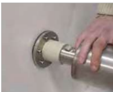
Opwikkelsbuis draaien tot de inlegspie kan geplaatst worden.
