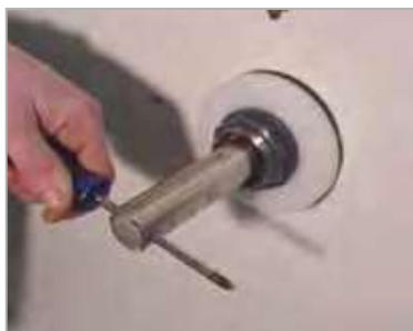
TIP! Gebruik boorgat bij spiebaan om as te manoeuvreren.
