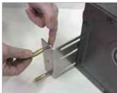
Tapbout + plug aan motorbeugel draaien en vet in de motorbuis aanbrengen.
