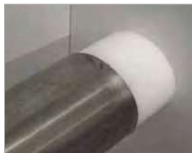
Buis in lagerblok schuiven.
